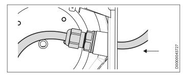
Führen Sie das Netzanschlusskabel von der Geräterückseite durch die Kabelverschraubung.
